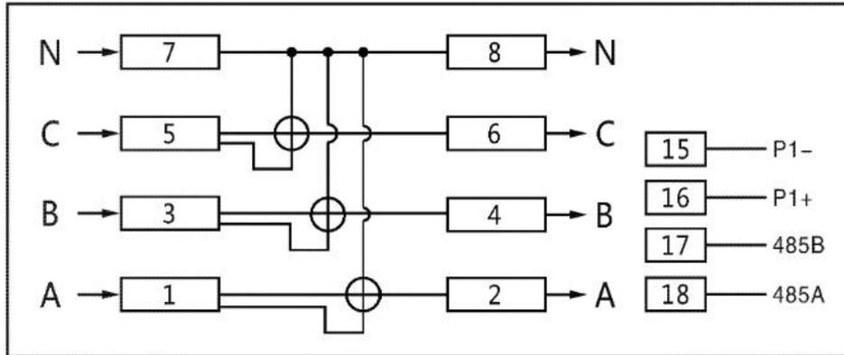
三相四线制经互感器接入式接线图如下：
